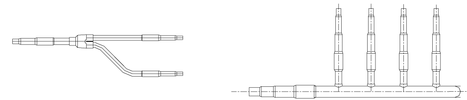
Y manifold pipe
