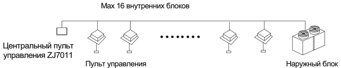
Рис.10.1 -Подключение одного наружного блока к пульту ZJ7011
