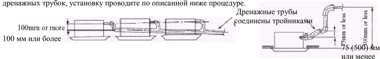
Выбирайте дренажные трубы с калибром, соответствующим производительности блока.
