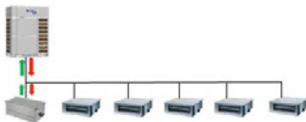
Режим розморожування з накопиченням тепла
