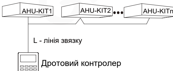
Мал.3.2 Один дротовий контролер до кількох АНУ-KIT
