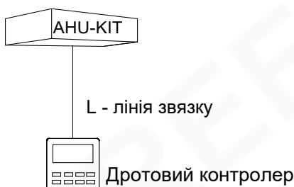
Мал.3.1 Один дротовий контролер до одного АНУ-KIT
