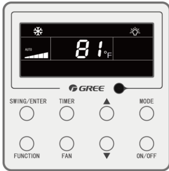
Fig. 4.3 Interface of On status in Fahrenheit
