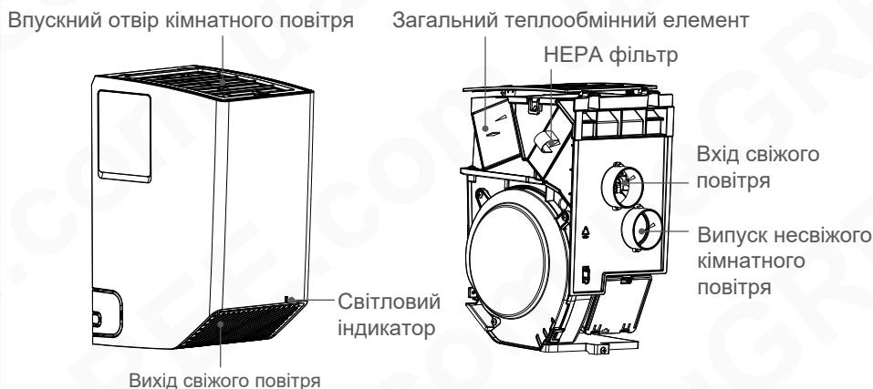
Принципова схема будови агрегату
