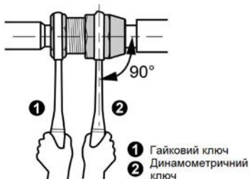
Малюнок 3-2 Кріплення з'єднувальної труби
