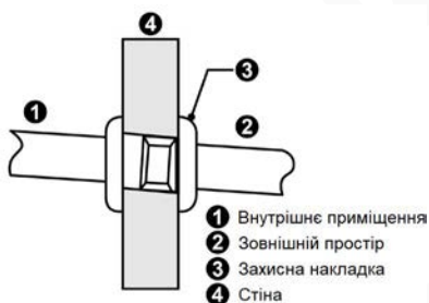
Малюнок 3-1 З'єднувальна труба холодоагенту через стіну
