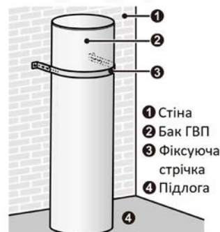
Малюнок 2-1 Принципова схема встановлення резервуара для води
