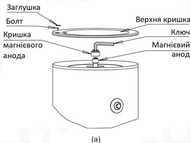
Малюнок 9-1 Заміна магнієвого анода
