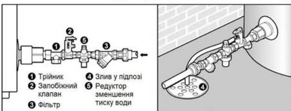
Спосіб встановлення 3 (тиск холодної води на вході перевищує 0,5 МПа)
