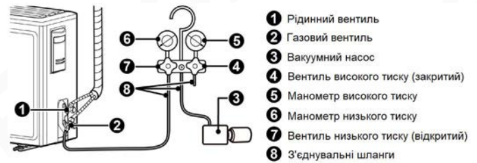
Малюнок 4-1 Підключення вакуумного насоса
