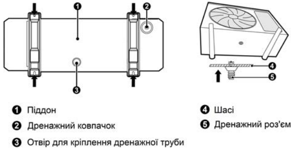
Мал. 3.4-1 Підключення дренажної труби
