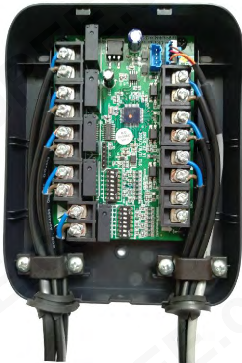
Мал. 5.3 Приклад підключення дротів
